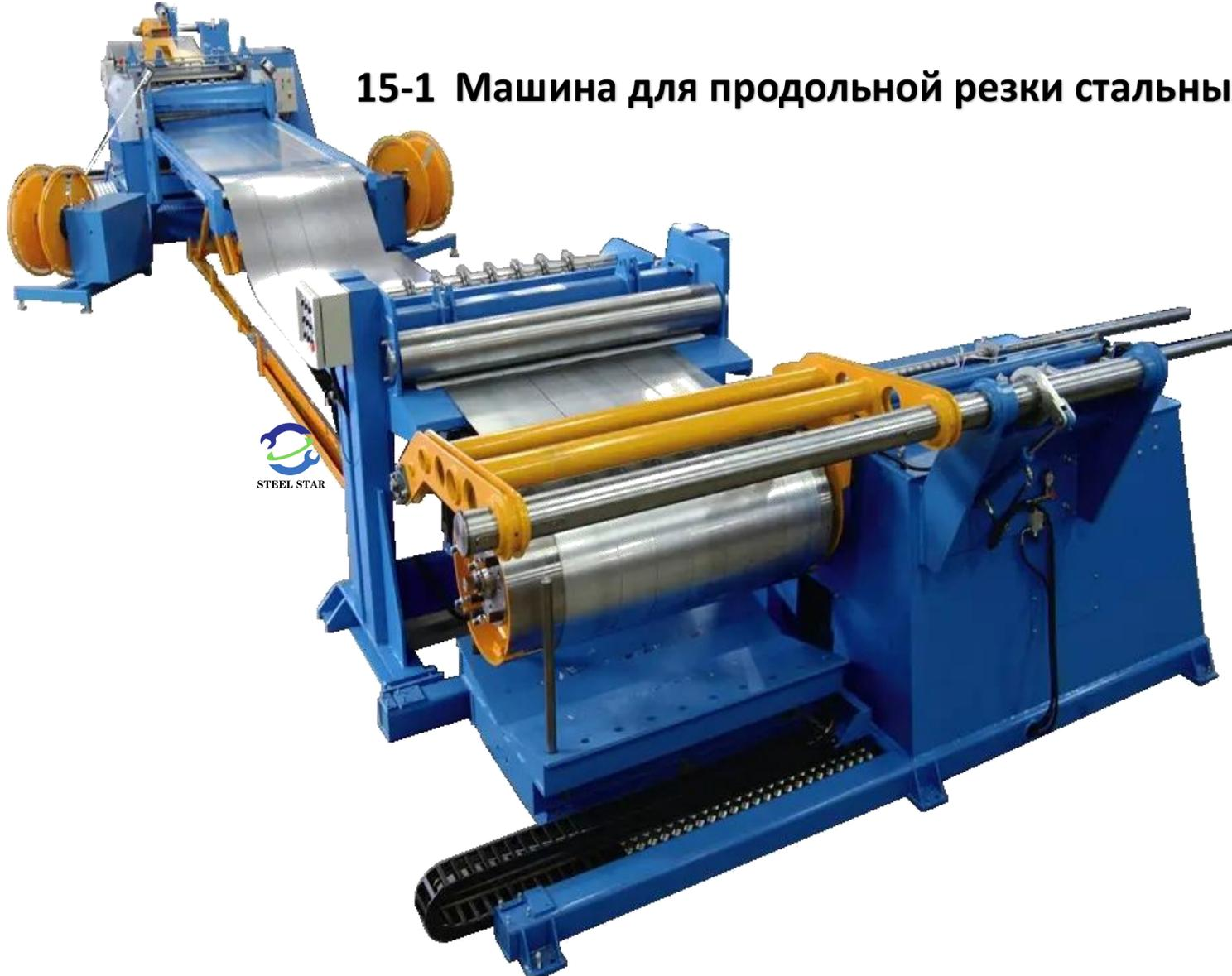
**15-1 Машина для продольной резки стальных рулонов**
