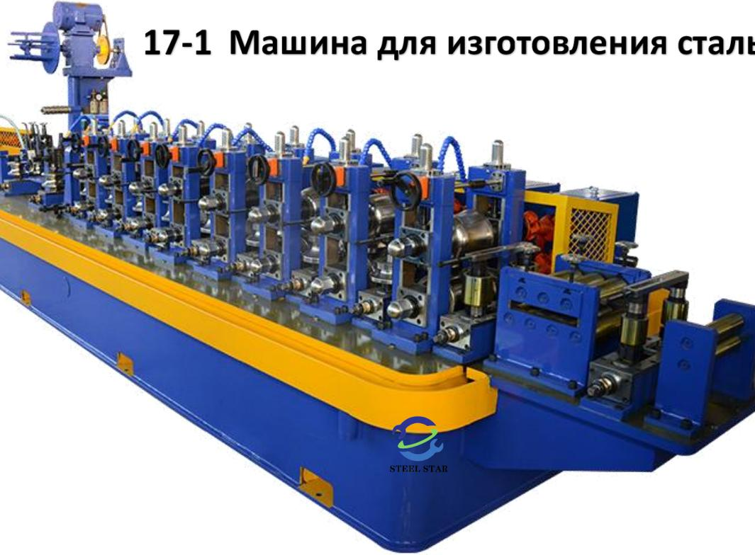
**17-1 Машина для изготовления стальных труб**
